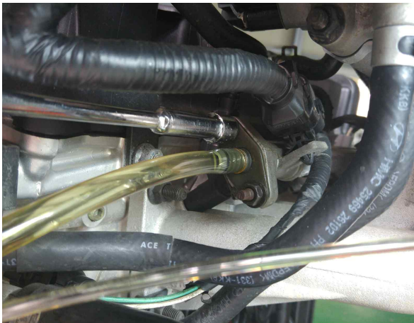
[그림 1-22] 연료 압력 게이지 설치(흡기 다기관)
