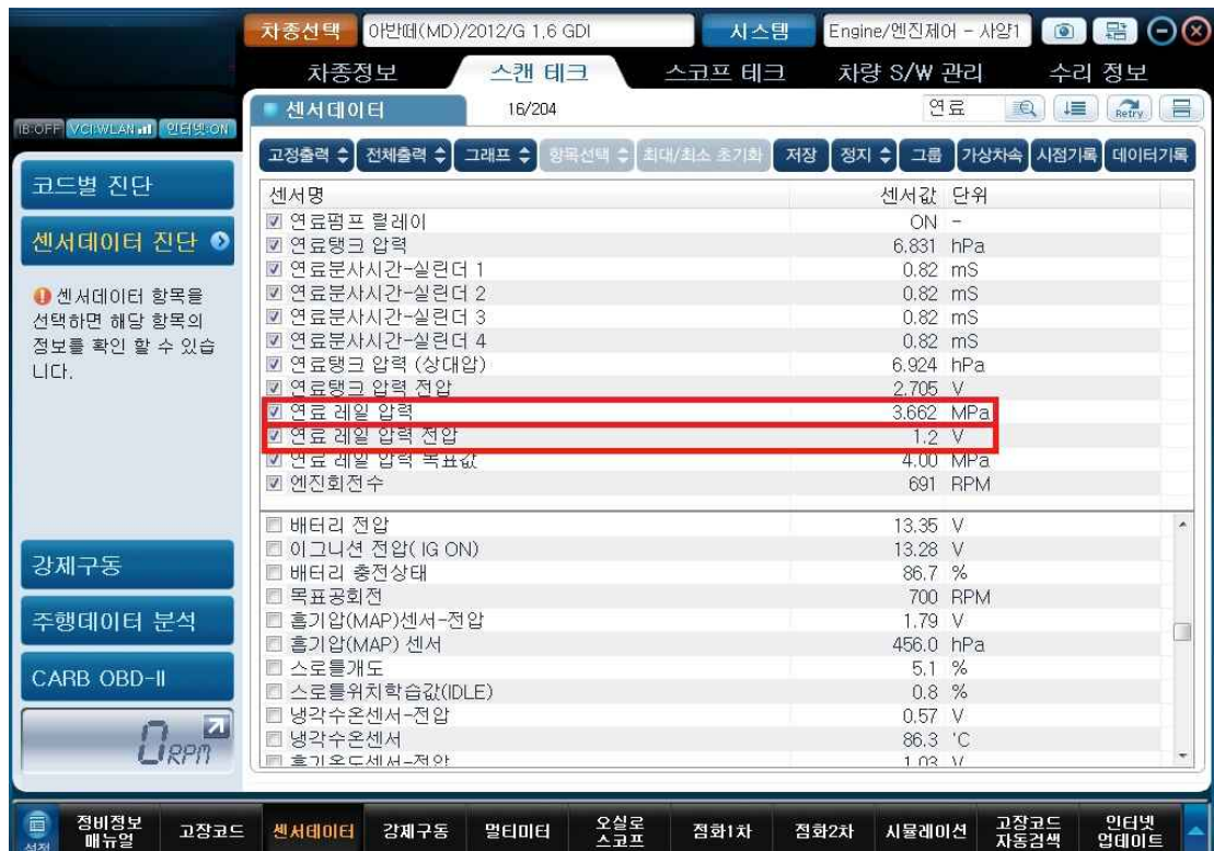
[그림 2-30] 센서 데이터를 이용하여 레일압력 및 전압 점검(공회전 상태)
