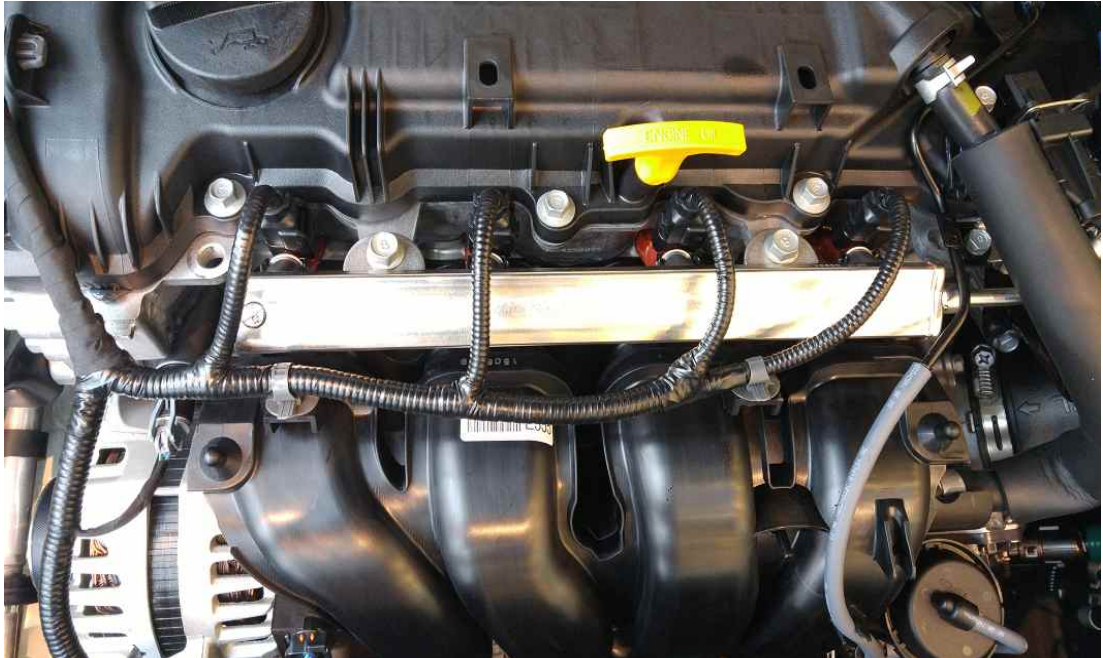
[그림 1-2] MPI 연료장치 구조
