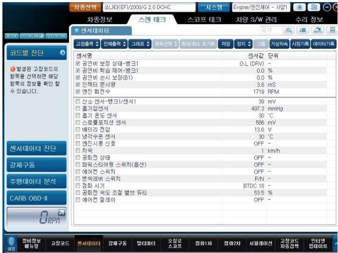
[그림 1-28] 연료 계통 관련 데이터(MPI 엔진)
