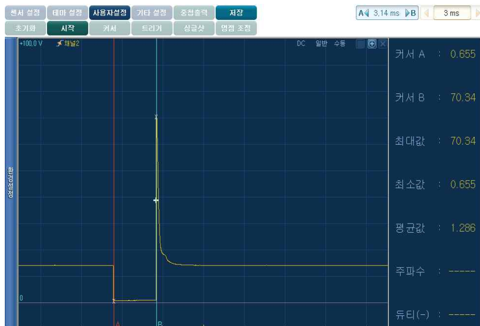
[그림 2-28] 인젝터 파형 화면(엔진 종합 진단기)
