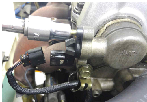
[그림 2-21] 크랭크각 센서 부착 볼트 탈거 1
