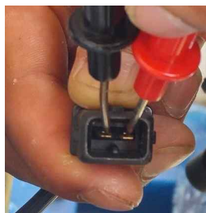
[그림 1-46] 크랭크샤프트 포지션 센서(CKPS) 저항 측정 단자
