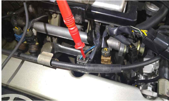
[그림 2-39] 파워 트랜지스터에 프로브 설치
