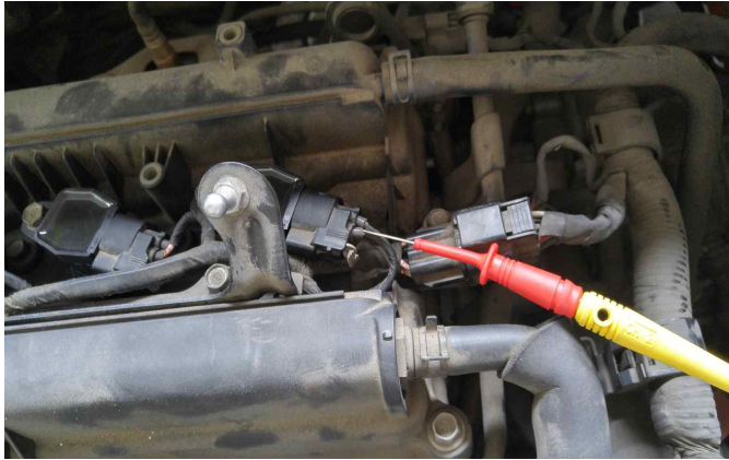
[그림 2-30] 점화 코일에 프로브 설치 1
