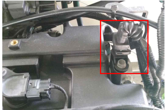
[그림 1-24] CMP(캠샤프트 위치센서)
