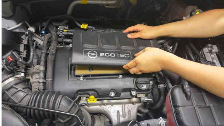
[그림 2-7] 엔진 커버 탈거(DIS 타입 2)
