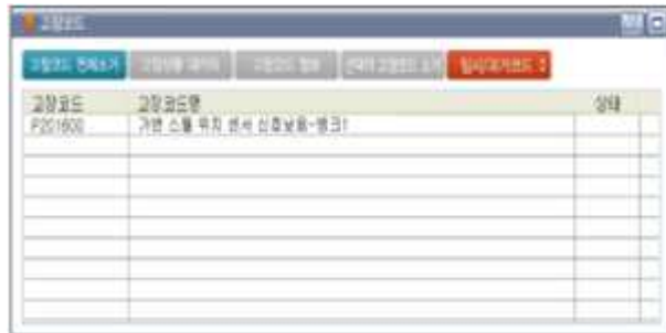
[그림 2-10] 가변 흡기 위치 센서 스캐너 검사
