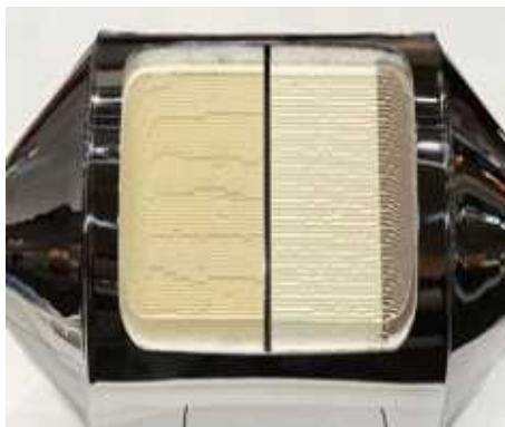
[그림 1-21] 삼원 촉매장치 (catalytic converter)
