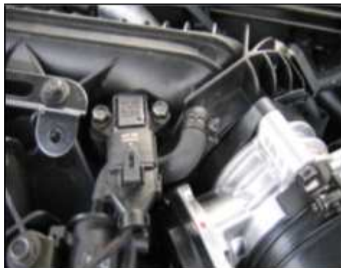
[그림 1-17] 전자 제어 스로틀 시스템 MAP 센서
