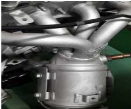
[그림 1-23] 삼원 촉매장치 (catalytic converter) CCC형
