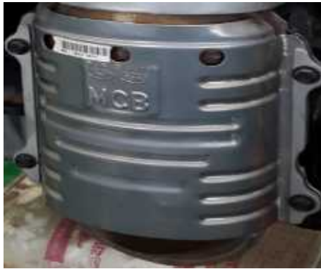
[그림 1-22] 삼원 촉매장치 (catalytic converter) MCC형
