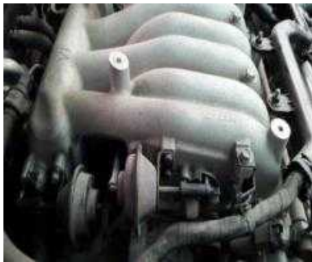
[그림 1-32] 가변흡기 시스템(VIS) 점검 (진공식)
