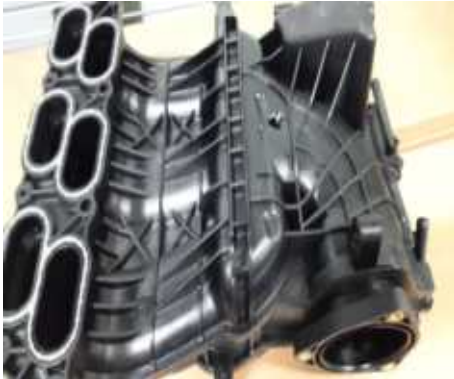
[그림 2-8] 가변 흡기 시스템(VIS) 점검(진공식)
