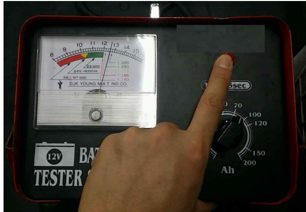
[그림 1-15] 축전지 용량 부하 시험
