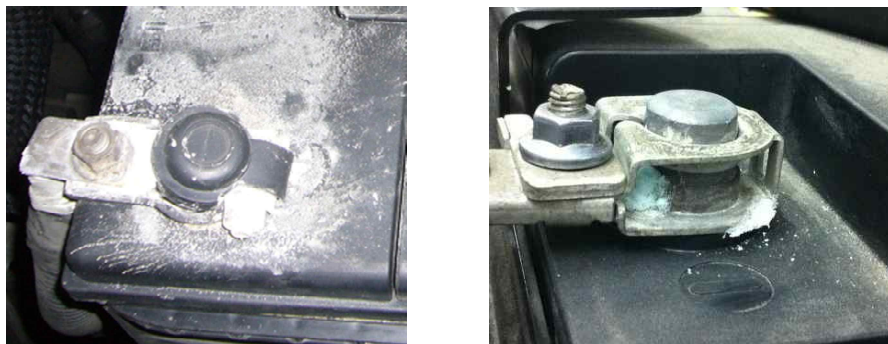
[그림 1-28] 축전지 단자 오염 상태
