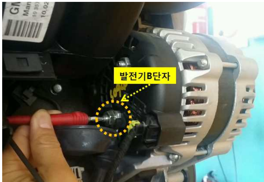
[그림 2-39] 발전기 B단자에 오실로스코프 신호계측 프로브 연결
