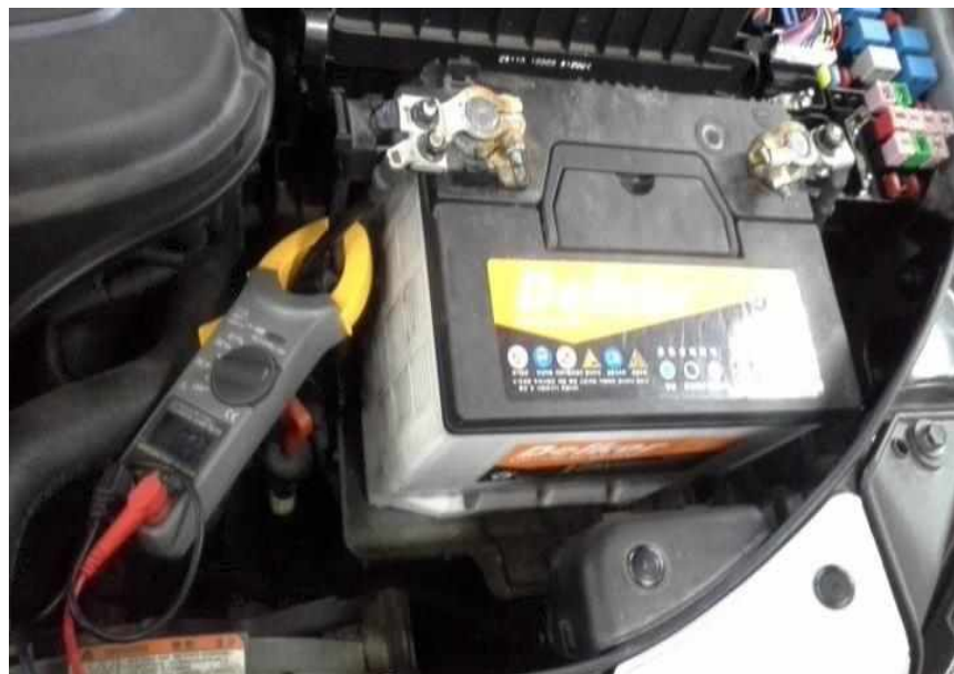
[그림 1-18] 후크메타를 활용한 발전기 충전 전류시험
