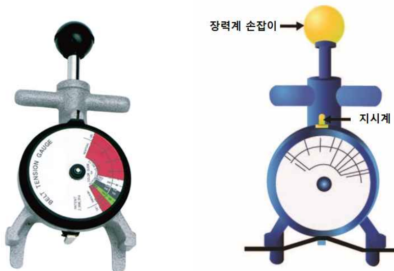
[그림 2-18] 기계식 장력계를 이용한 구동벨트 점검
