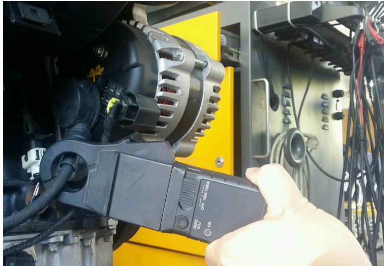
[그림 2-37] 발전기에 오실로스코프 전류계 장착
