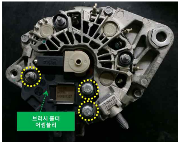
[그림 2-26] 발전기 브러시 홀더 어셈블리 분리
