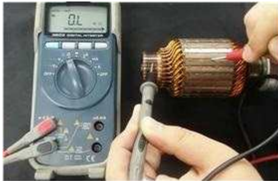
[그림 2-29] 시동전동기 정류자와 전기자 축, 전기자 코일 코어 통전 시험
