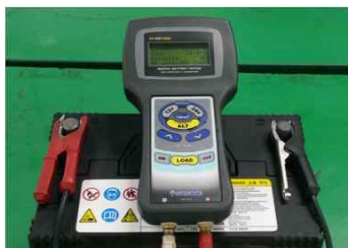
[그림 1-19] 축전지 부하시험기 설치
