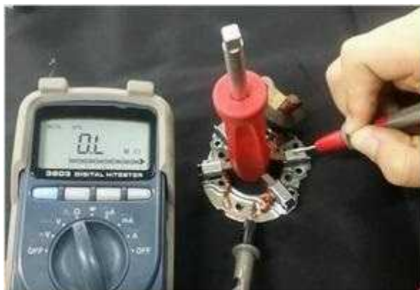
[그림 2-30] (+)브러시 홀더와 (-)플레이트 통전 시험
