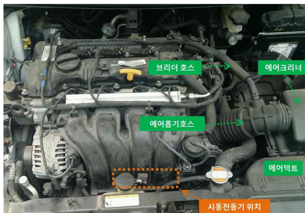
[그림 2-6] 에어크리너 어셈블리 및 브리더호스, 에어흡기호스, 에어덕트 분리
