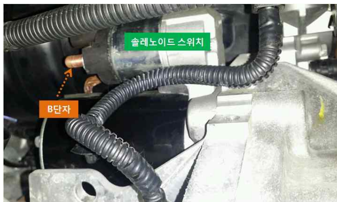
[그림 2-9] 솔레노이드 스위치의 B단자 케이블 탈거
