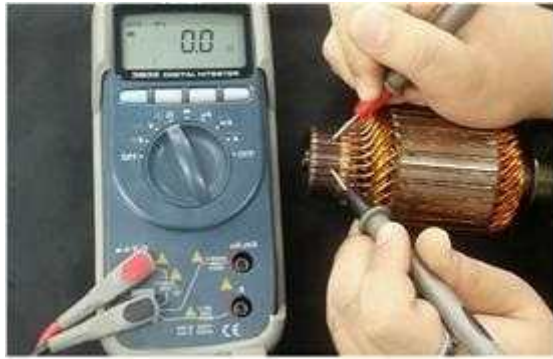
[그림 2-28] 시동전동기 정류자 편 통전시험
