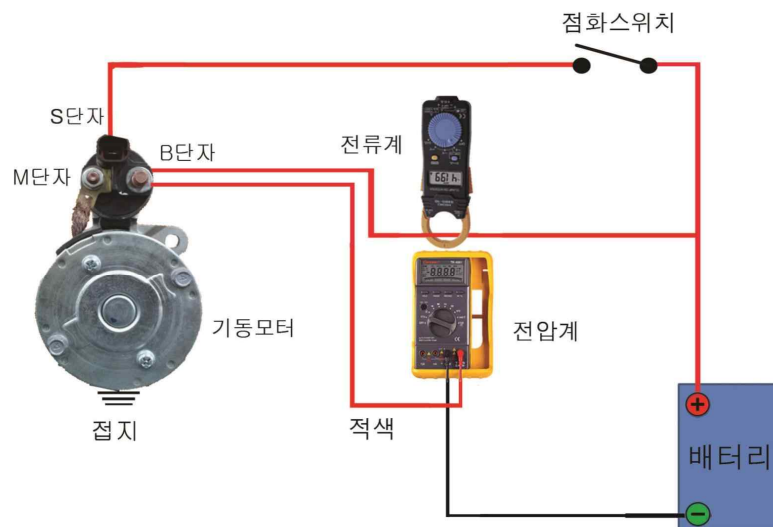
[그림 1-24] 시동전동기 부하 시험
