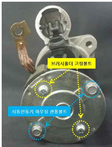
[그림 2-18] 브러시 홀더 및 전동기 하우징 고정볼트 제거
