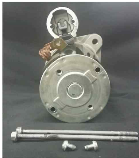
[그림 2-18] 브러시 홀더 및 전동기 하우징 고정볼트 제거
