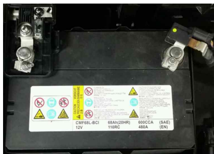
[그림 1-18] 축전지 단자 연결 점검 상태 확인
