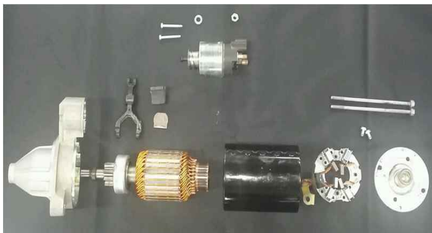
[그림 2-25] 시동전동기 전체 탈거 모습
