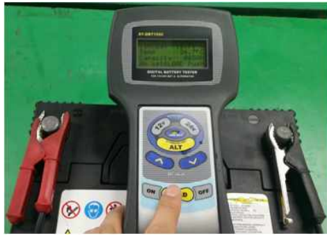
[그림 1-21] 축전지 부하 시험
