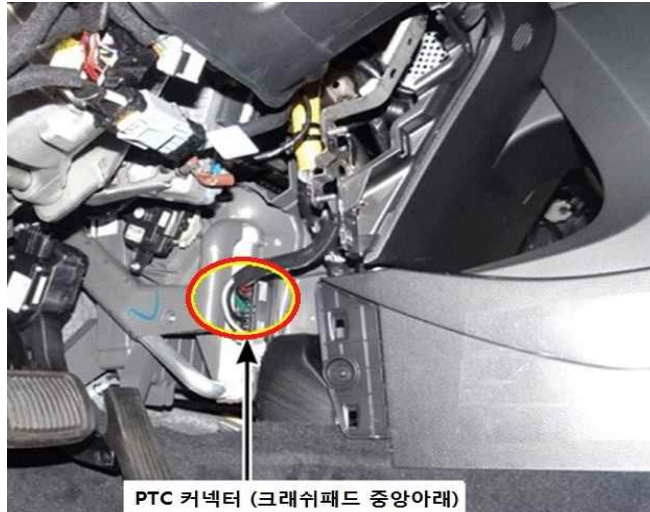
PTC 커넥터 (크래쉬패드 중앙아래) 출처: 현대자동차 GSW 홈페이지(www.globalserviceway.com). 2015년 8월 7일 검색. [그림 2-25] PTC히터 장착 위치
