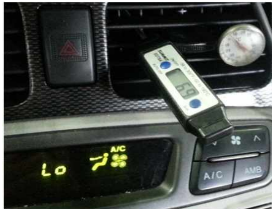
[그림 2-26] VENT 토출구 건구온도 측정
