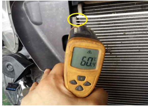
[그림 2-18] 콘덴서 입·출구 온도 측정
