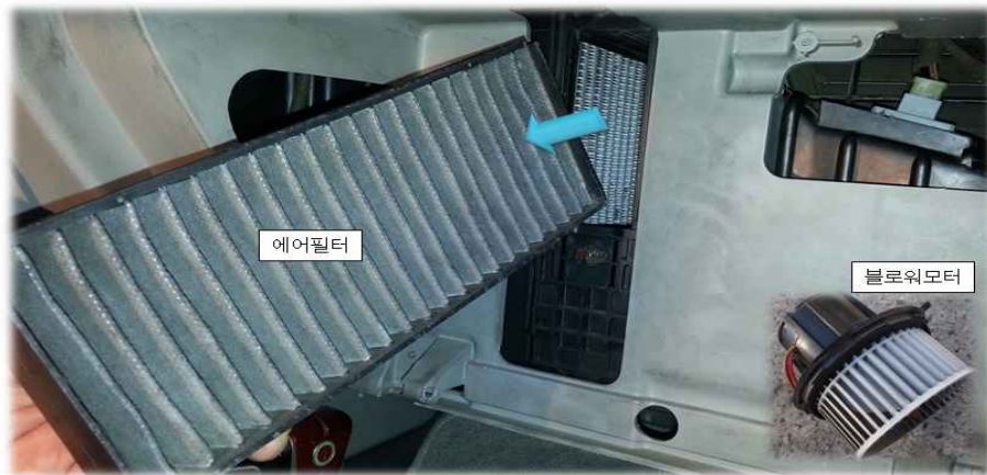
[그림 2-20] 에어필터와 블로워모터 장착 위치
